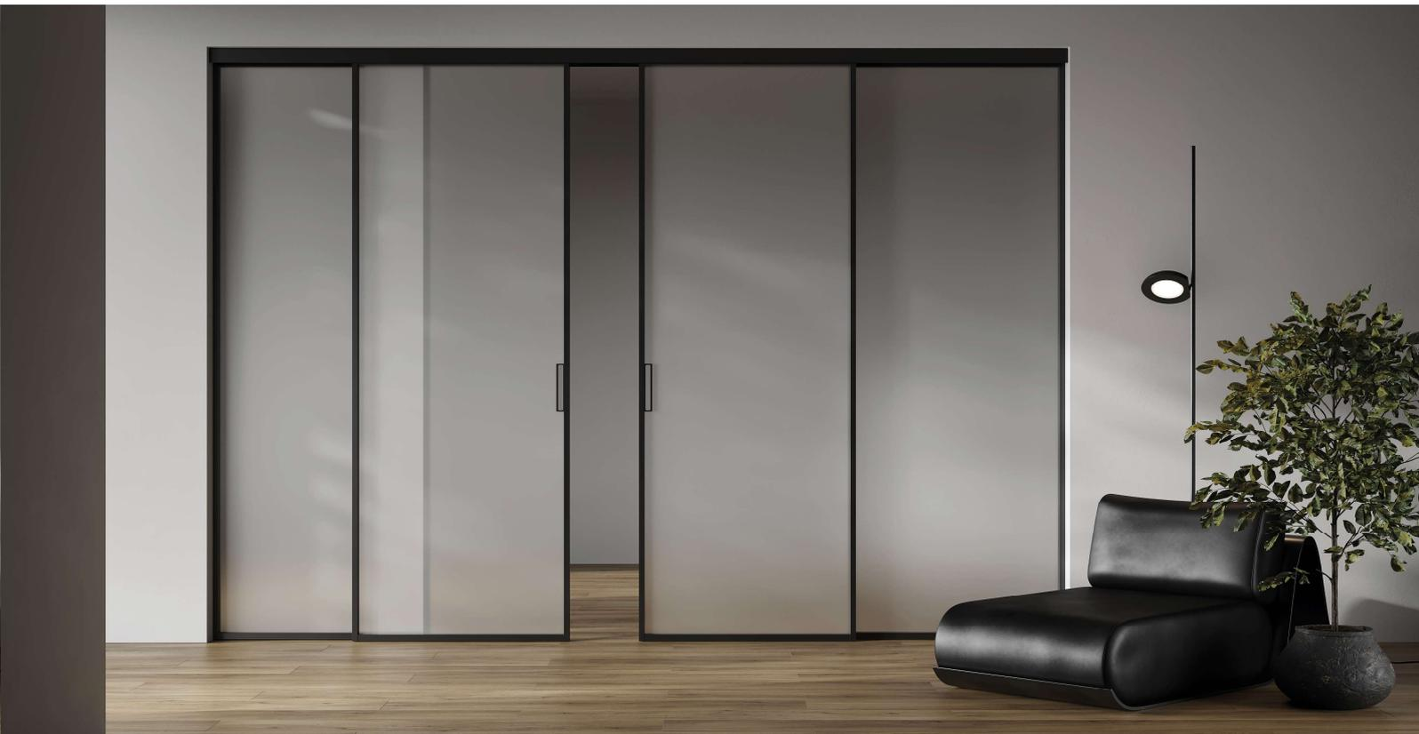
Система направляющих SYNTESES ULTRA 05, представляет собой решение с использованием декоративного карниза для раздвижных дверей, толщиной не более 40 мм и общим весом не более 120 кг, размещенных внутри проема. Максимальное количество полотен в системе: 4
